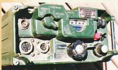
Station Radio B47: met een frequentie bereik van 38-56 MHz in 181 kanalen met 100 kHz kanalen afstand. Gelijk aan de C42/C45. De set draait op 24 volt. De antenne afstemeenheid op de Champ is linksvoor geplaatst. Zowel de C42/C45 als de B47/48 gebruiken de standaard radio tuner Frequency Aerial No. 6.
